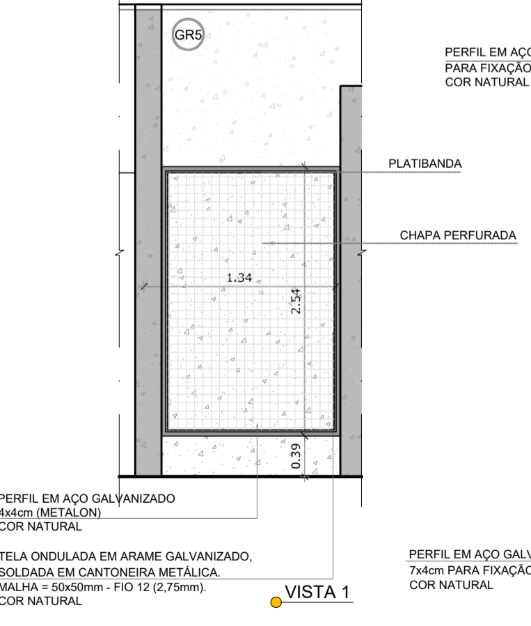
5 GRADIL 5 - BLOCO F, H ESCALA 1/50
